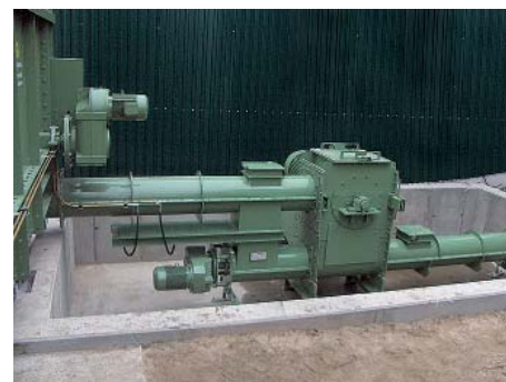
Zerkleinerungstechnik in den Förderweg integriert
