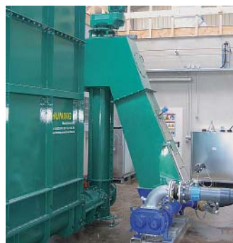
Übergabe vom Feststoffdosierer in Pumpsysteme
