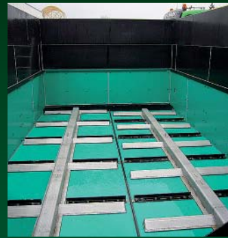
Kunststoffauskleidung, Edelstahlschubboden Baureihe SBC
