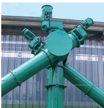
Vertikalspiralförderweg mit 2 alternativen Fermenter-eintragsförderwegen
