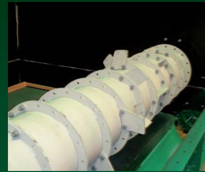
Dosier- und Auflösewalze mit auswechselbaren Werkzeugen in Edelstahlausführung
