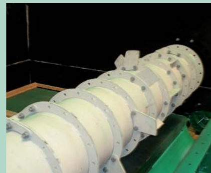
Wał dozujący oraz rozdzielający z narzędziami wymiennymi w wersji ze stali szlachetnej
